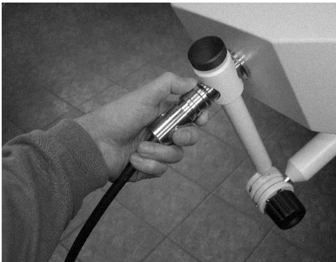
Abbildung 3: Lösen des HF-Kabels vom Strahler
