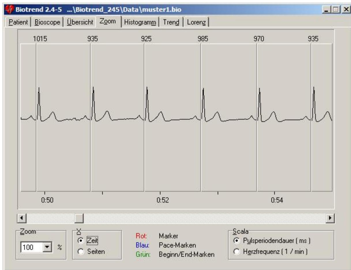
Wählen Sie „Zeit“ in der Programmgruppe X, um eine zeitliche Datenreferenz zu erhalten (m:ss) oder „Seiten“, um sich an den Seitenzahlen des Bioscope zu orientieren, welche dort oben, mittig im Display während der Speicherung angezeigt werden.
