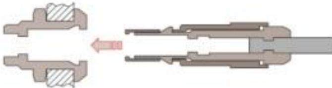
Achten Sie beim Einföhren des Steckers auf die Nuten in der Buchse und die Nasen am Stecker.
