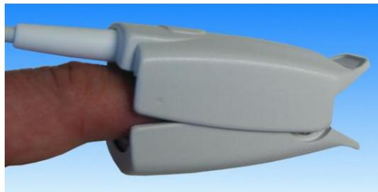
Bild 6: Fingerclipsensor des BIO-3A
