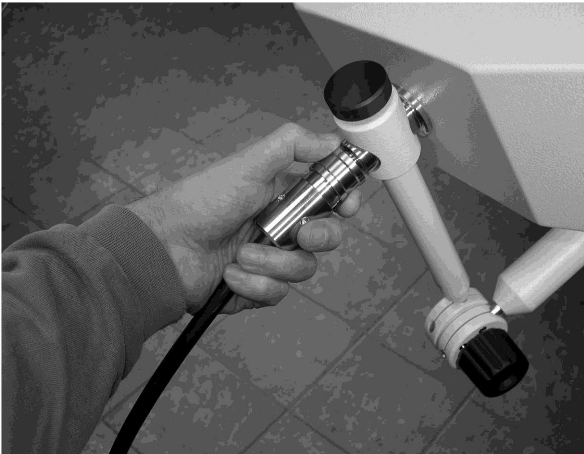
Abbildung 3: Lösen des HF-Kabels vom Strahler
