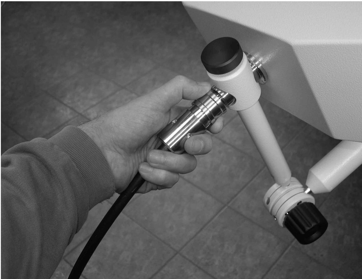
Abbildung 4: Lösen des HF-Kabels vom Strahler
